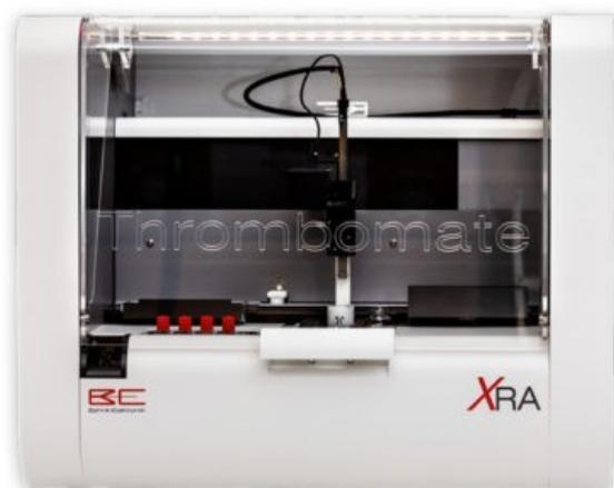
Sistema totalmente automatizado para la transmisión de luz por agregometría (LTA) que ofrece resultados de alta calidad de la función plaquetaria. Aplicaciones de prueba para numerosas concentraciones de agonistas. Posibilidad de operaciones de agregometría LTA 24/7.
