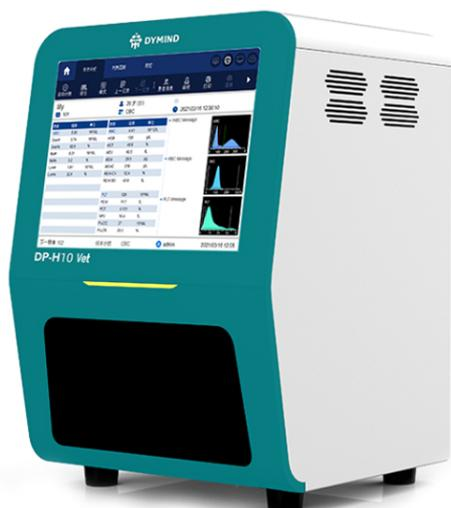
Analizador hematológico de 3 poblaciones POCT para veterinaria diseñado para ofrecer resultados precisos y rápidos en el análisis de muestras sanguíneas de animales. Función mediante el método de impedancia para las pruebas de WBC, RBC y PLT. Método colorimétrico sin cianuro para la prueba de HGB. Inmunonefelometría para CRP y SAA.
