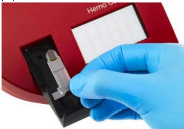
Paso 2: Coloque la microcubeta en el analizador
