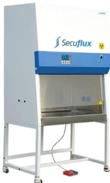
Cabina de Seguridad Biológica Clase II A2 BSC X Secuflux permite manipular microorganismos garantizando la seguridad para el usuario. Perfecta para uso en servicios de Microbiología. Con filtro HEPA, Dos, 99,999 % de eficiencia a 0,3  $\mu\text{m}$ ; indicador de la vida del filtro.
