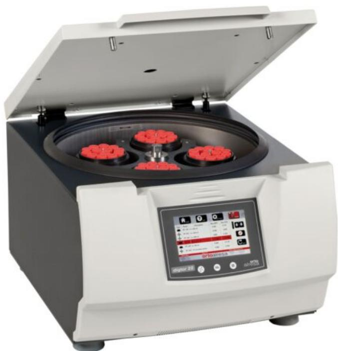
Centrífuga de sobremesa que combina las características de equipos para gran capacidad y altas velocidades, obteniendo como resultado una centrífuga para rutina con especificaciones de otros segmentos superiores y que dispone de un amplio rango de accesorios. Cuenta con pantalla TFT táctil a color. Incluye rotor RT 277 de 4 x 750 ml.
