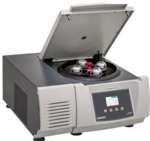
Centrífuga refrigerada de sobremesa de grandes dimensiones configurada para tener capacidad de hasta 28 tubos de 15ml. Incluye adaptadores RE512 y RE516 para tubos de máximo 13x107 mm. Compatible con tubos de 5, 7 y 10 ml. Dispone de sistema REI (Rotor Easy to Install) para carga rápida y fácil del rotor.
