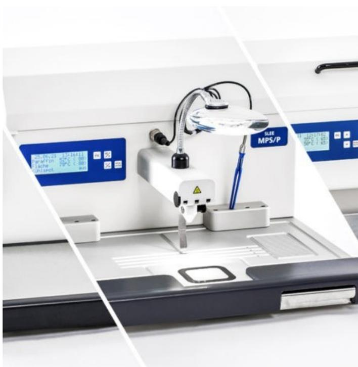
Unidad modular de inclusión en parafina de fácil manejo. Amplia zona de trabajo y un contenedor de parafina de 5,5 litros de capacidad. Compuesto por 3 módulos ensamblables que funcionan a la misma altura de trabajo: 1 [Módulo Dispensador de parafina MPS P](#), 1 Módulo de precalentamiento MPS W y 1 Placa de refrigeración MPS C o MPS CX.
