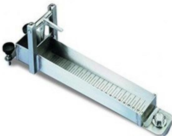
Consistómetro de acero inoxidable para determinar la uniformidad de los materiales viscosos midiendo la distancia hasta la que fluye el material por su propio peso, en un intervalo de tiempo determinado.
