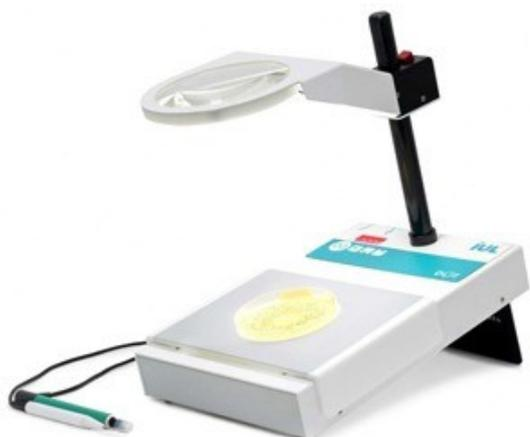
Contador de colonias que facilita y acelera el proceso de conteo de colonias, mediante el uso de iluminación LED y una lupa de alta calidad. Especialmente diseñado para laboratorio de microbiología
