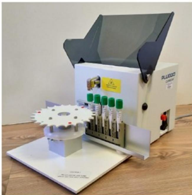
Destaponadora de tapones Pluggo compatible con los racks de tubos de vacío de Hitachi para Roche. Válido para dimensiones de tubos de 13x75 mm, 13x100 mm y 16x100 mm
