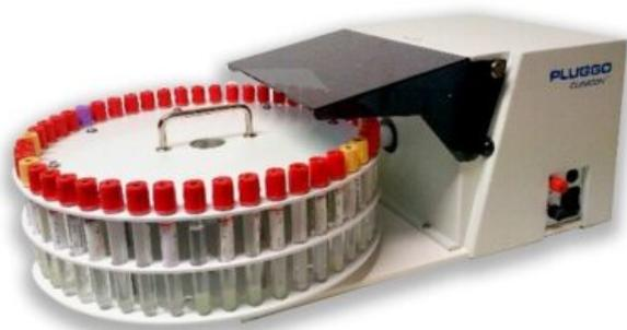
Retirada cómoda y segura de hasta 50 tapas originales de tubos de extracción de sangre de vacío, por presión. Compatible con tubos de 5 ml, 7 ml, 7 ml largos y 10 ml, de diferentes marcas del mercado.
