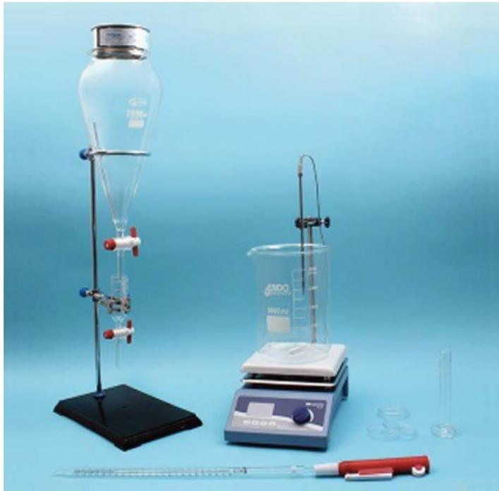
Equipo para llevar a cabo el análisis por medio del método de digestión de muestras colectivas con utilización de un agitador magnético.
