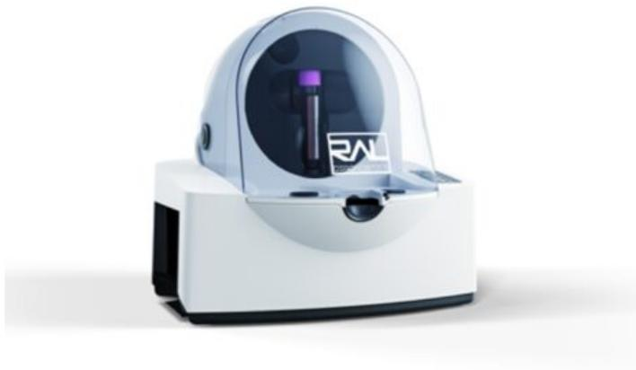
Dispositivo automatizado de muestreo de viales cerrados para frotis de sangre para laboratorios con pequeñas cargas de trabajo. Evita todo contacto directo entre el usuario y la muestra de sangre.
