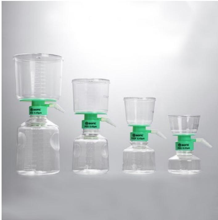
Cafetera de filtración para vacío con membrana de 0,22 µm PVDF. Perfecta para la separación y purificación de muestras de grandes volúmenes de 150 a 1000 µm
