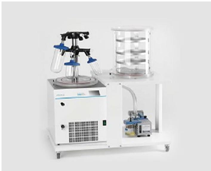
Liofilizador compacto de laboratorio para aplicaciones de amplio espectro, volumen 4 litros y una temperatura de enfriamiento de hasta  $-110^{\circ}\text{C}$ .
