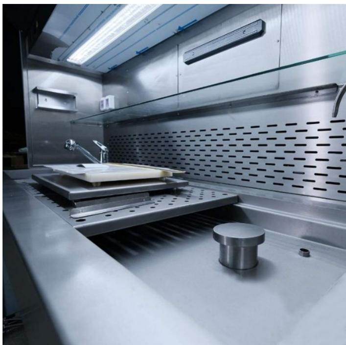
Estaciones de tallado, con sistema de preparación y dispensación automática de formalina. Cuenta con ventilación de tiro descendente y de retroceso que mantiene al usuario a salvo de la inhalación de productos químicos durante el trabajo. Base ventilada. Especialmente diseñadas para optimizar la seguridad y con opción a fabricar en distintas longitudes según las necesidades del laboratorio de Anatomía Patológica.
