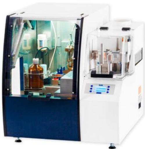
Montador de cubreobjetos modular de dimensiones reducidas para automatización del montaje de cubres en portaobjetos. Agiliza el trabajo de preparación de las muestras en el laboratorio.
