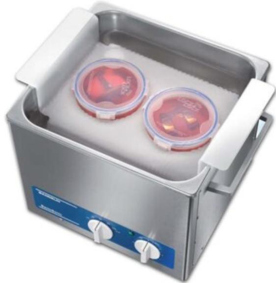
Baño de Ultrasonidos con Cubeta interior de acero inoxidable, rápido y de alta eficacia para la extracción del componente bacteriano de los biofilms sobre implantes.
