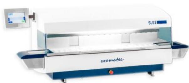
Sistema de tinción flexible y de alta productividad que permite estar trabajando con 20 cestillos de portaobjetos a la vez, y con 5 cestillos de carga y 5 de descarga, lo que lo acerca a un teñidor de trabajo en continuo. Incluye estación calefactada que puede ser empleada como estación previa de des-parafinización o como estación de calentamiento.
