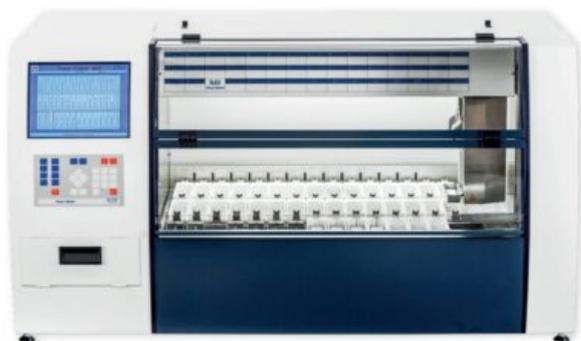
Teñidor compacto multi protocolo flexible y rápido, que abre una nueva dimensión en el campo de la automatización. Gracias a su alto número de estaciones, configurable hasta 44, es posible trabajar simultáneamente con diferentes protocolos de tinción.
