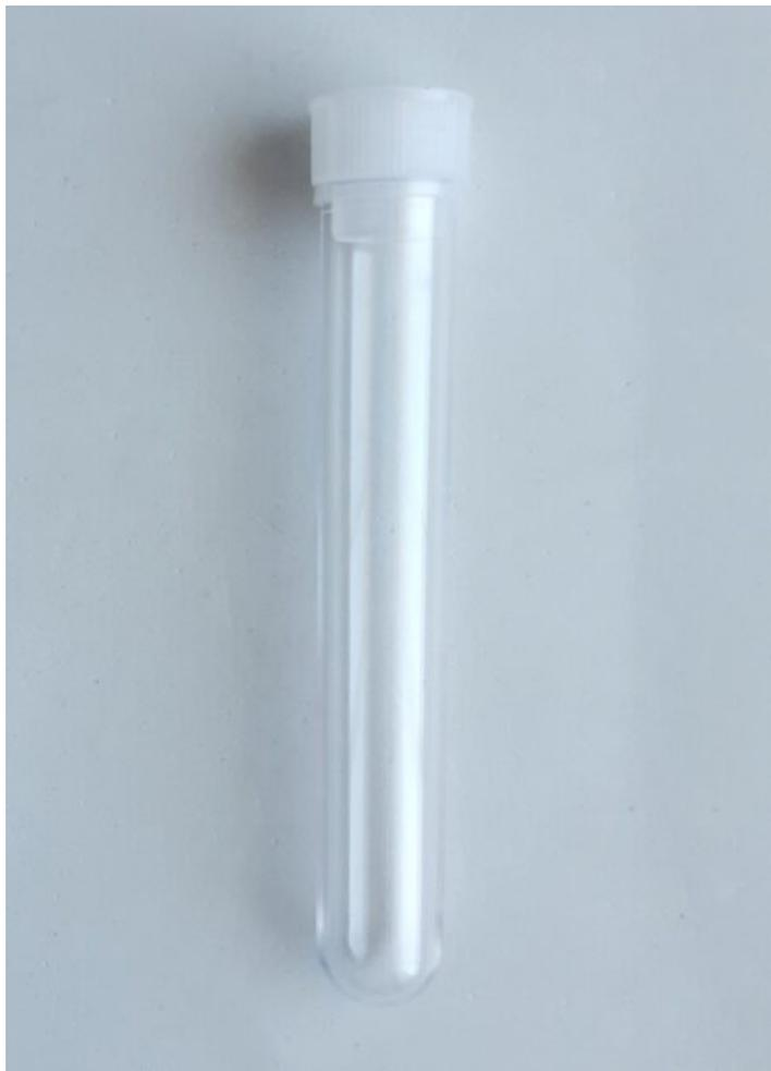
Tubo de poliestireno cristalino transparente de un solo uso, de 11 mm. de diámetro, 70 mm. de longitud y 3 ml. de capacidad nominal, fondo redondo, con tapón a presión de polietileno color blanco de 11 mm. de diámetro.
