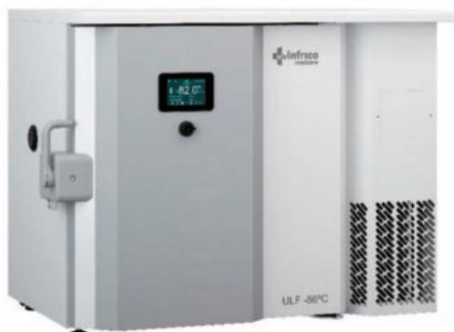
Ultracongelador bajo bancada de 110 litros de capacidad nominal. Rango de temperaturas desde -40°C hasta -86°C con Data logger, representación gráfica y USB para facilitar la recogida de datos
