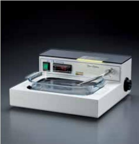
Dotato di vaschetta rimovibile in pirex (capacità circa 1,2 litri) per un facile riempimento e svuotamento dell'acqua e per garantire una maggiore sicurezza e praticità d'uso. Il controllo della temperatura avviene tramite una sonda direttamente a contatto con l'acqua, provvista di dispositivo di sicurezza che interrompe l'alimentazione elettrica quando si asporta la vaschetta. Il piano di appoggio superiore è riscaldato e può ospitare fino a 24 vetrini.
