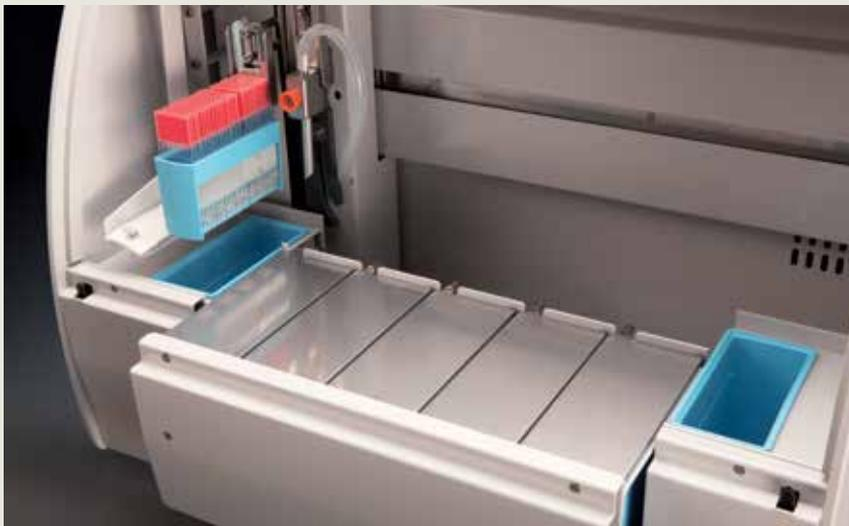
Coloratore automatico per microbiologia, ematologia e anatomia patologica con sette stazioni, cinque per i reagenti, una per il lavaggio e una per l'asciugatura dei vetrini. Disponibile anche nella versione con sei stazioni per i reagenti e una stazione di lavaggio per colorazioni di ematosilina-eosina per estemporanee.
