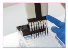
Load using a multichannel pipette
