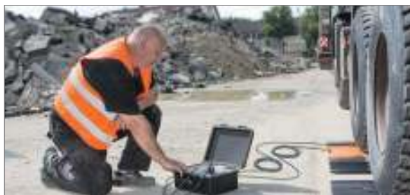
Pesaje de tractores, remolques, camiones etc. para controles del ámbito del suministro y entrega de mercancías en lugares en los que no se cuente con una báscula para vehículos fija por motivos de costes u otros
