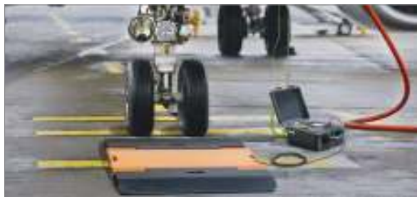
Pesaje de aviones para el cálculo del plan de carga y la determinación del centro de gravedad, para garantizar que no se sobrepase el peso total permitido y que el peso se distribuya correctamente.
