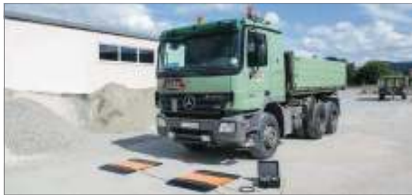
Pesaje de camiones, caravanas, remolques, etc. para controles (de policía) rápidos, con independencia del lugar, de pesos del eje para la detección y prevención de cargas defectuosas o sobrecarga
