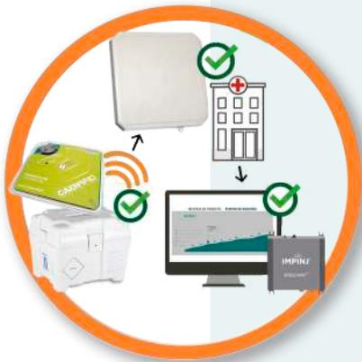
· SecuTag es una solución integral para el transporte de especímenes entre Centros de Atención Primaria y Hospitales de forma segura. Se basa en un conjunto de dispositivos por Radiofrecuencia (RFID) y una Aplicación de Software que dan trazabilidad de tiempos y temperaturas desde la expedición de la nevera hasta su llegada al Laboratorio
