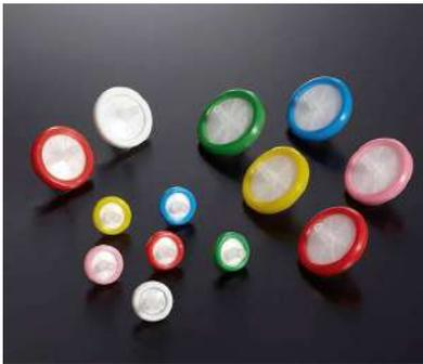
Filtro de jeringa membrana PES (polietersulfona), Útiles para preparación, esterilización y purificación de volúmenes pequeños de muestras, medios de cultivo, etc.
